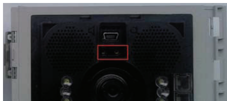
Umístění potenciometrů na audio/video jednotce
