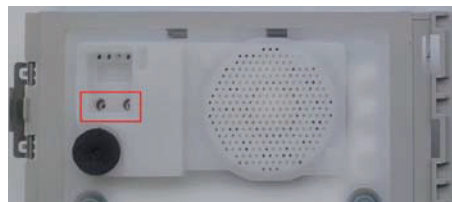
Umístění potenciometrů na audio jednotce
